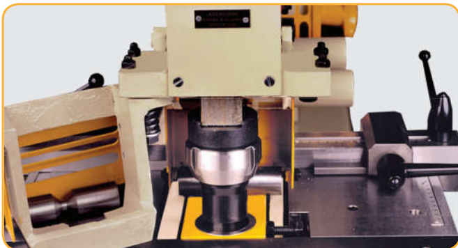
Ponsinstallatie voor diameters t/m 36 mm Ø in 8 mm dik
